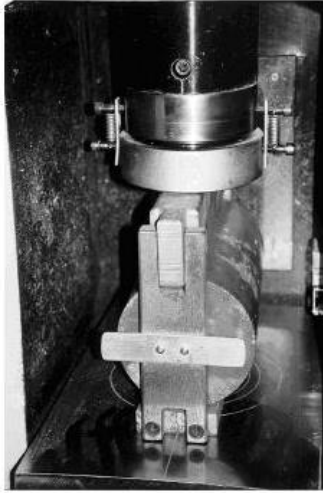
Hình 5 - Mẫu để xác định cường độ chịu kéo khi bừa được đặt trong máy nén
