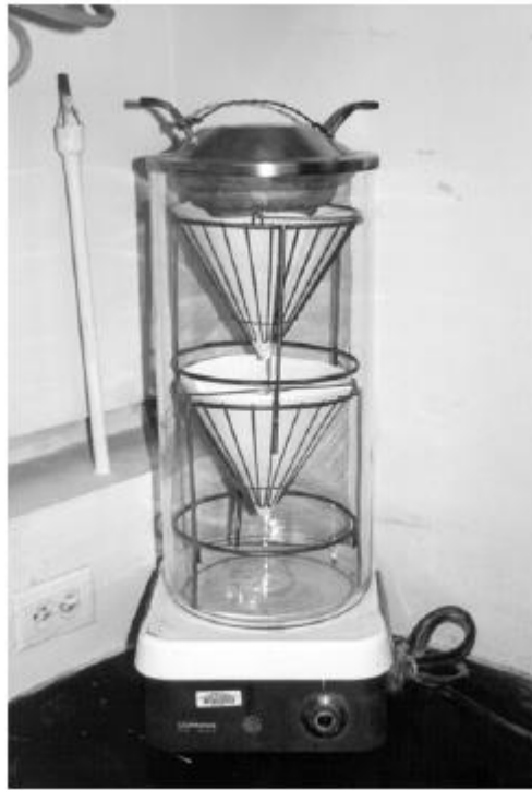
Hình 2. Thiết bị tách nhựa (Phương pháp B)
